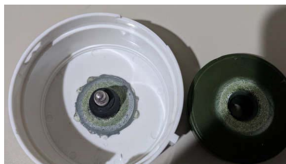
B. Condition du moteur en cas de fonctionnement sans d'eau
