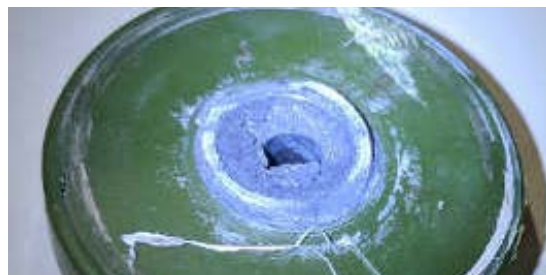
C. Condition du moteur en cas de fonctionnement avec d'eau partielle
