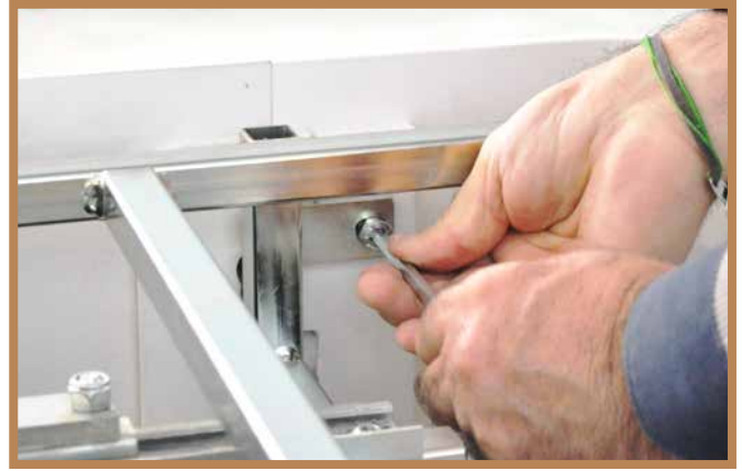
PASSO 2: Svitare le 4 viti con l'apposita chiave per togliere il carter di legno posteriore
