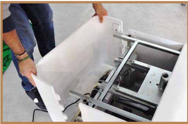
PASSO 3: Sfilare il carter di legno posteriore
