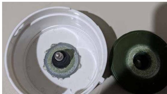
B. Condizione della girante rovinata per ASSENZA DI ACQUA
