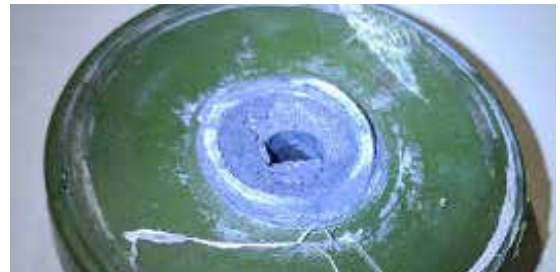
C. Zustand des Laufrades für TEILBEFÜLLUNG ruiniert
