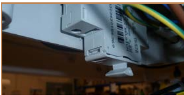
Fig. 2 - Fusible de chauffage (10A) Ce fusible est situé à l'intérieur de l'unité de contrôle. Retirez le couvercle en dévissant les 4 vis pour ouvrir le boîtier de l'unité de commande et remplacer le fusible.
