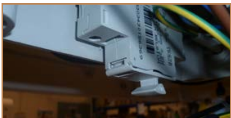
Figura 2 - Fusibile Riscaldamento (10A) Questo fusibile è posizionato all'interno della centralina. Togliere il coperchio svitando le 4 viti per aprire la scatola della centralina e sostituire il fusibile.
