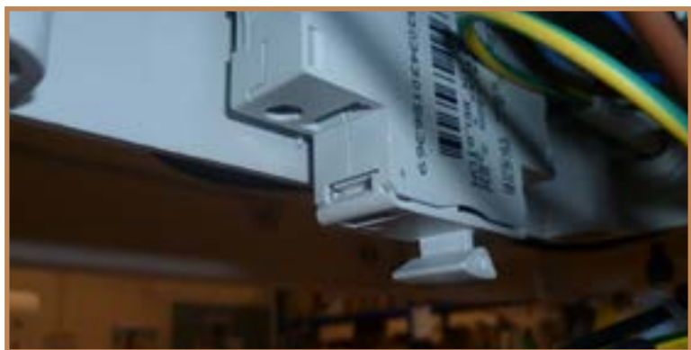
Fig. 2 - Sicherung für Heizplatte (10A oder 16A) Diese Sicherung befindet sich im Schaltkasten. Lösen Sie die 4 Schrauben vom Schaltkastendeckel, um diese Sicherung zu wechseln.
